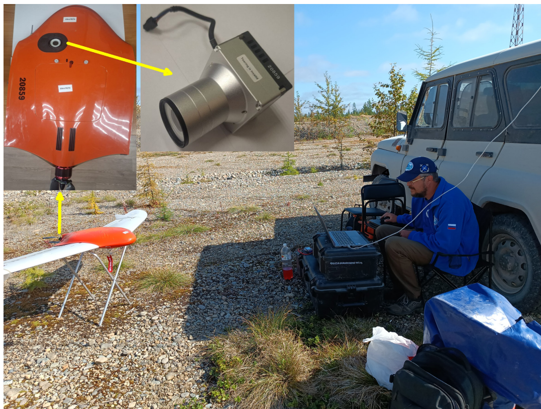
Рис. 3. Работа специалистов Хабаровского филиала ВНИРО с промышленным БПЛА Геоскан 201, оснащённым фотокамерой Riebo R6 (матрица – 61 Мп). В верхнем левом углу – вид БПЛА с нижней стороны; жёлтой стрелкой указана камера.
