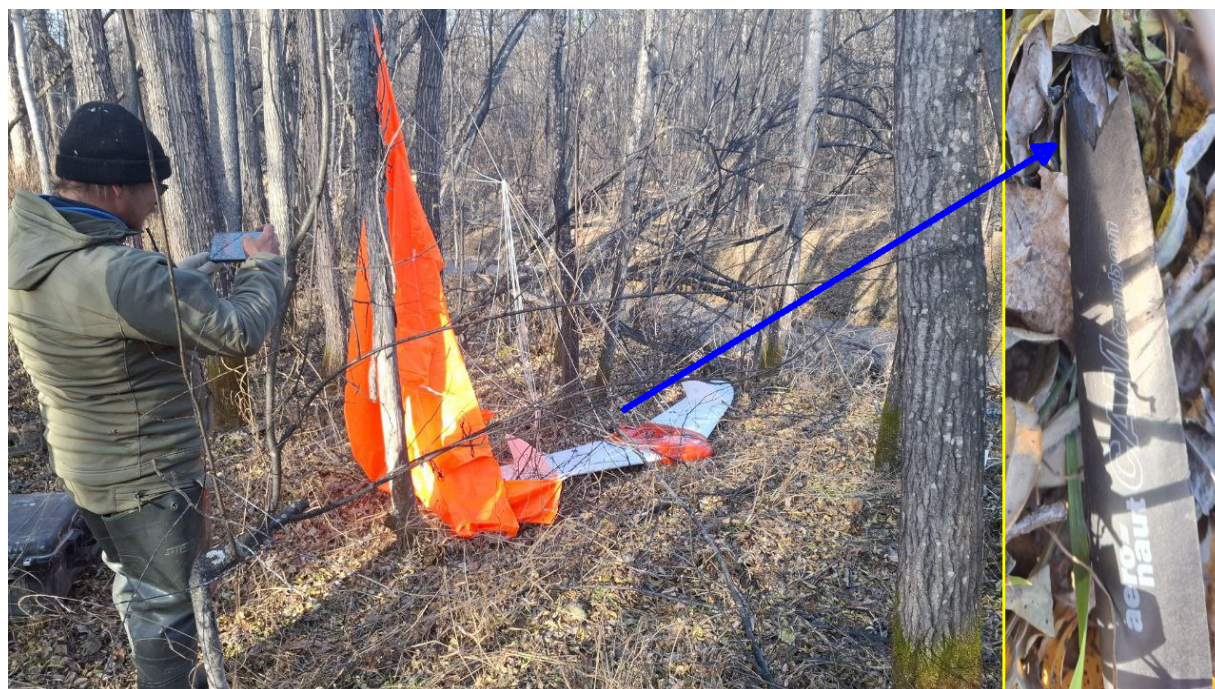
Рис. 4. Место аварийного приземления Геоскан 201. Стрелкой обозначена разрушенная лопасть винта.
