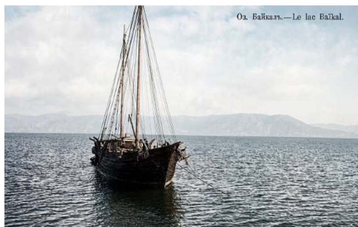
Рисунок 8. На открытке начала XX в. (подкраска ИИ) изображено грузовое парусное судно на оз. Байкал. На таких и подобных им парусных судах с XIX в. через Байкал возили бочки с засоленной рыбой и другие грузы. Длина судов достигала 25 метров, они имели одну или две мачты. Перевозили не только грузы, но и людей. От устья Селенги до Иркутска (около 165 км) подобное судно доходило в течение 1-2 суток.
