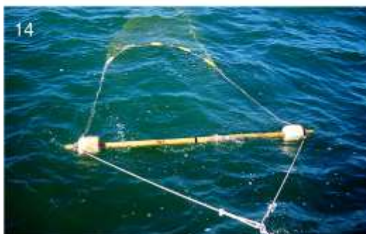
Рис. 2.6. Бим-трал 2,0×8,2 м для контрольного лова молоди рыб в пелагиали (А – схема траловой системы. Б – основные элементы оснастки трала: 1 – бим; 2 – ваер; 3 – верхний кабель; 4 – нижний кабель; 5 – груз-углубитель; 6 – буксировочная доска; 7 – буксировочные оттяжки; 8 – уздечки; 9 – верхняя подбора; 10 – наплава; 11 – нижняя подбора; 12 – грузила. В – примеры работы с тралом: 13 – р. Камчатка, июль 2010 г.; 14 – прибрежные воды Охотского моря в районе устья р. Хайрюзова, август 2012 г.; 15 – устьевая область р. Пенжины, август 2014 г.; 16 – Пенжинская губа, август 2015 г.).
