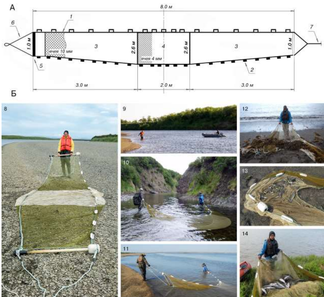
Рис. 2.7. Закидной невод 8,0×2,6 м для контрольного лова рыб на литорали (А – сборочный чертеж с основными элементами невода: 1 – верхняя подборка с наплавами; 2 – нижняя подборка с грузами; 3 – крылья; 4 – сливная часть; 5 – кляч; 6 – уздечка; 7 – урез. Б – примеры работы с неводом: 8 – р. Таловка, август 2014 г.; 9 – р. Белоголовая, июль 2012 г., 10 – р. Ловаты, северная часть Пенжинской губы, июль 2015 г.; 11 – устье р. Ича, июнь, 2018 г.; 12 – бух. Вилучинская, июнь 2019 г.; 13–14 – р. Вывенка, июль 2021 и 2022 г.).
