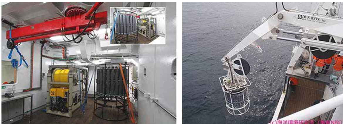
Рис. 3. Внутреннее устройство ангара на НИС VERO INAPESCA (слева) и вид снаружи ЦЗР тип 1 на НИС Kagoshima Maru с СПУ типа кран-LARS (справа)
