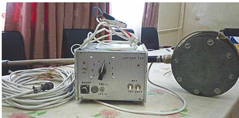
Рис. 2. Малогабаритный электромагнитный стимулятор «ЭМИ»: излучатель с мембраной из оцинкованного железа, соединительный кабель, генератор сигналов
