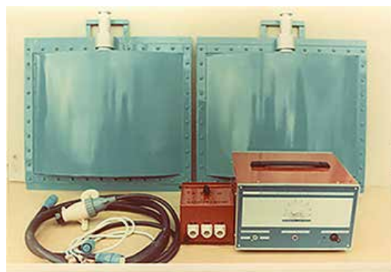
Рис. 1. Стимулятор «Сигнал-М»: с двумя излучателями, изготовленными из пластин кристалла сегнетовой соли, соединительный кабель, коммутатор, генератор сигналов
