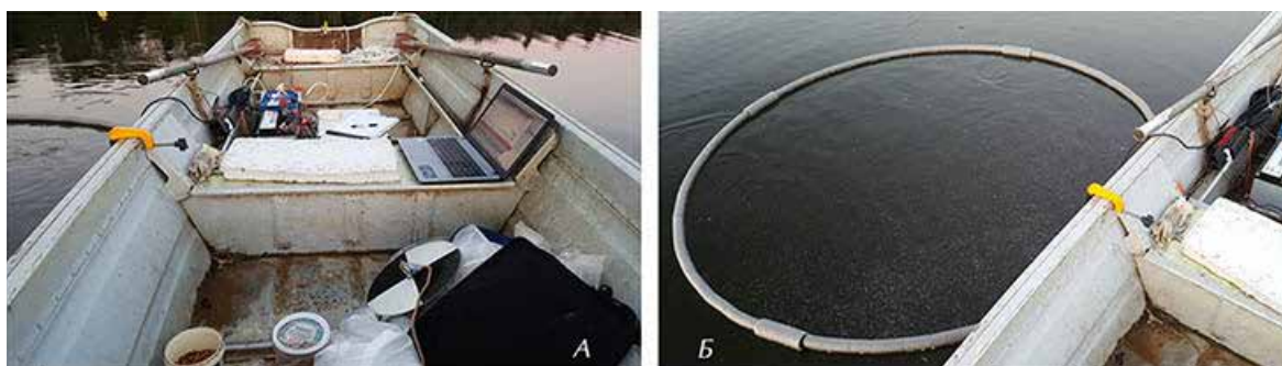
Рис. 10. Мобильный гидроакустический комплекс, размещённый на лодке (А); кормовая площадка (Б)
