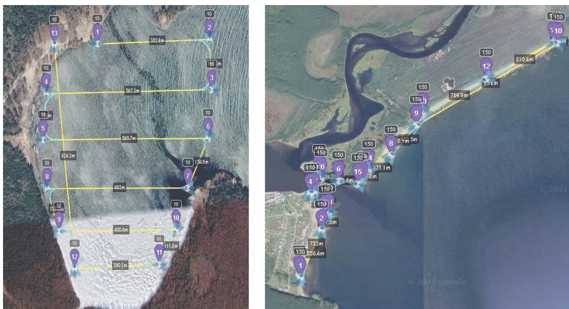
Рис. 1. Примеры планирования автономных миссий для выборочной фотосъёмки в бухте Фальшивая (слева) и тотальной фотосъёмки в бухте Датта (справа) в сентябре 2020 г. Числа обозначают номер путевой точки (в сиреновом значке), высоту полёта на данном участке миссии (в чёрном значке) и длину сегмента между смежными путевыми точками (в чёрном значке с окончанием «m») в метрах
