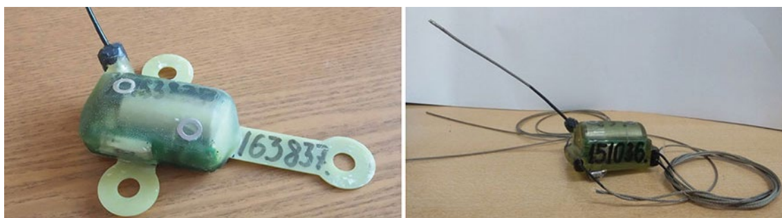
Рис. 1. Внешний вид спутникового радиомаяка, производства ООО «Эс-Пас» для косаток (слева) и белух (справа)
