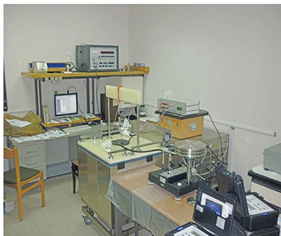
Рис. 1. Средства калибровки STD-зондов. Момент калибровки датчика давления и его температурной компенсации
