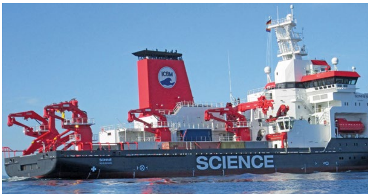
Рис. 2. Вид и расположение основных СПУ, установленных на корме и части правого борта НИС «Sonne»
