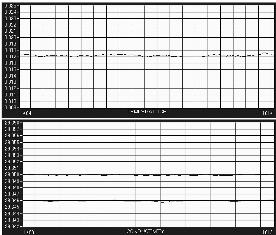
Рис. 1. Окно программы ICAL стандарта электропроводность–температура СТ-01. Верхняя часть — показания платинового термометра сопротивления СТ-01. Значения УЭП второй ячейки сдвинуты относительно первой на 0,004 мСм/см
