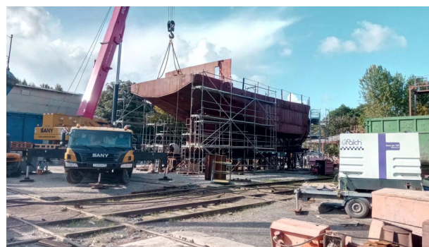
Рисунок 4. Сборка корпуса МСТР пр. 174610 «Всеслав» в городе Светлом Калининградской области
