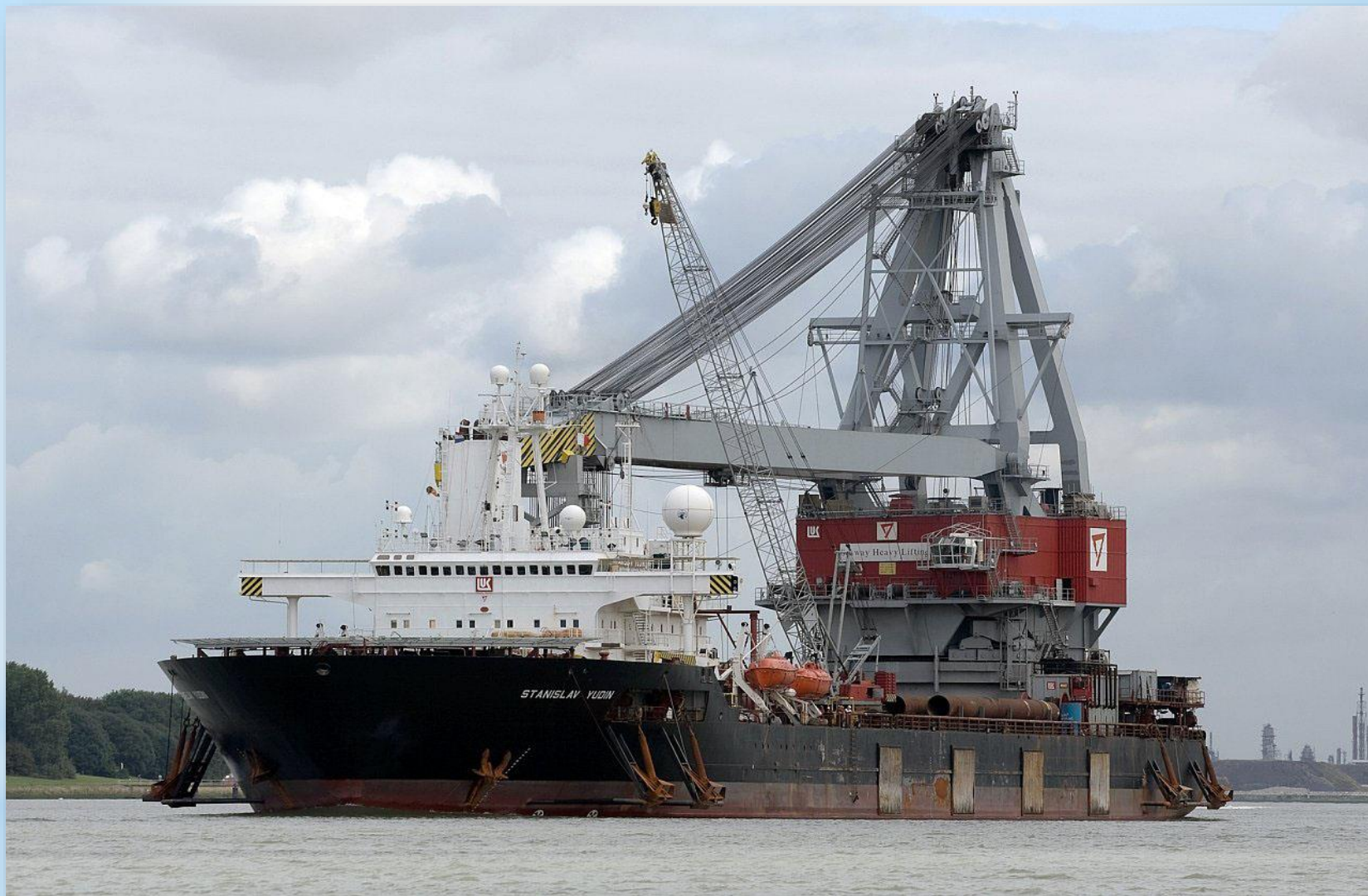
Крановое судно грузоподъёмностью 2500 тонн.
