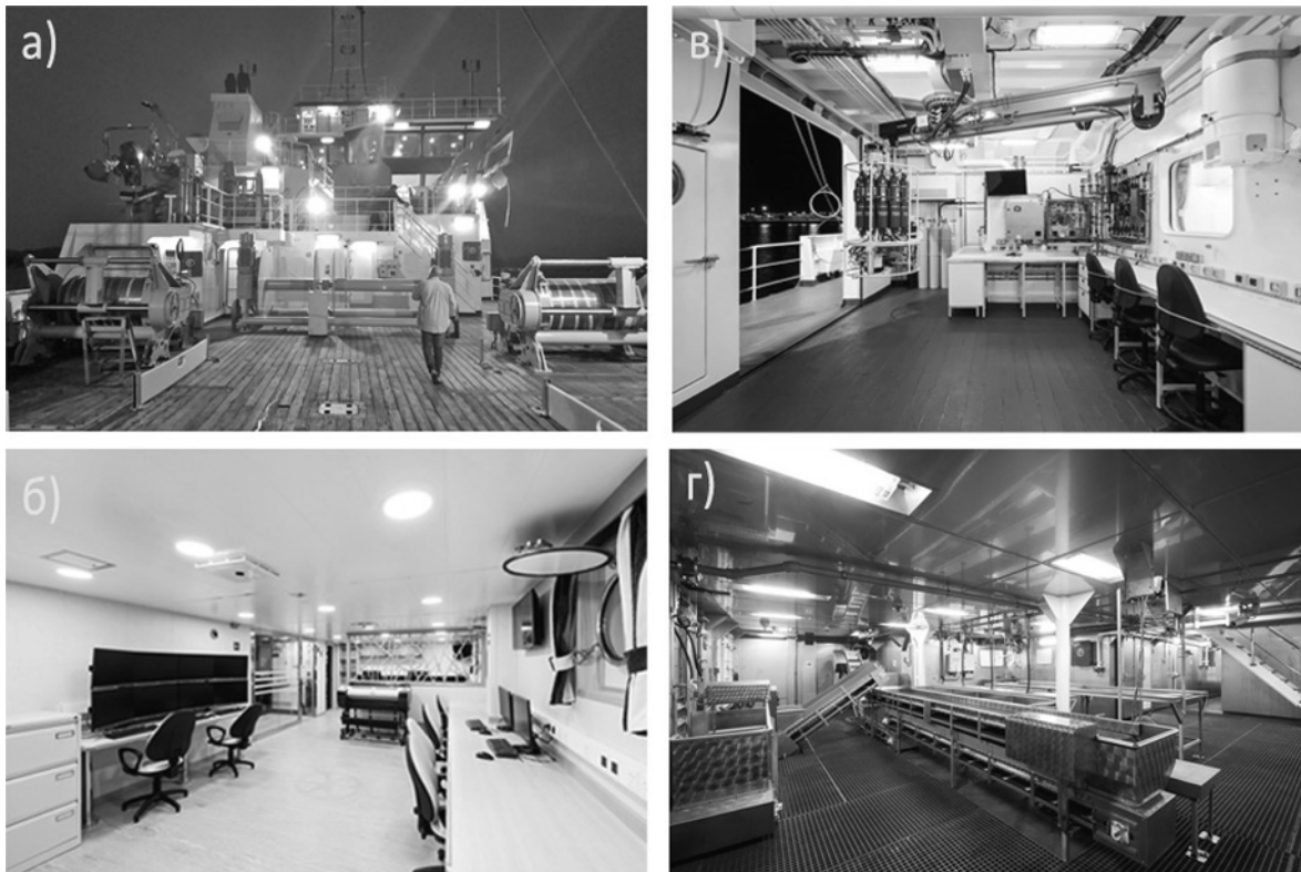
Рис. 3. Виды траловой палубы (а) и внутреннего устройства научных помещений НИС «Victor Angelescu» б — «сухая» лаборатория, в — ангар с «мокрой» лабораторией, г — рыбцех
