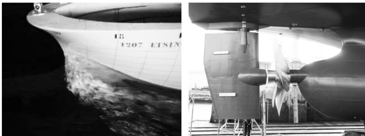
Рис. 1. Вид одной из моделей НИС «Victor Angelescu» с безбульбовым вариантом форштевня судна (слева) и готовой оконечностью гребного винта — перо руля (справа)
