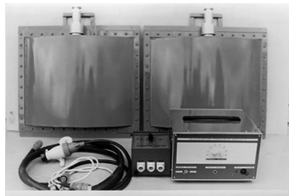
Рис. 1. Стимулятор «Сигнал-М»: с двумя излучателями, изготовленными из пластин кристалла сегнетовой соли, соединительный кабель, коммутатор, генератор сигналов
