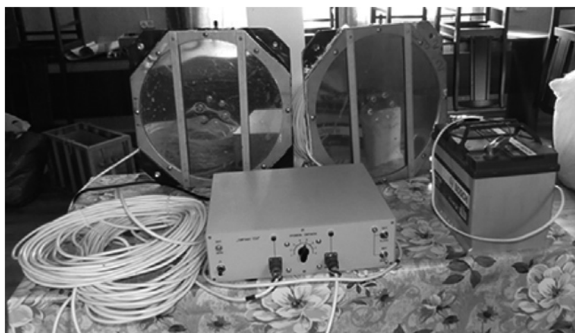
Рис. 3. Стимулятор «Сигнал-ТЗЭ»: два излучателя с мембранами из нержавеющей стали, соединительный кабель, генератор сигналов с возможностью одновременного подключения двух акустических излучателей, аккумулятор 12 Вольт
