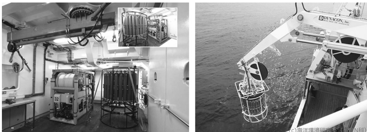
Рис. 3. Внутреннее устройство ангара на НИС VIPO IANAPESCA (слева) и вид снаружи ЦЗР тип 1 на НИС Kagoshima Maru с СПУ типа кран-LARS (справа)
