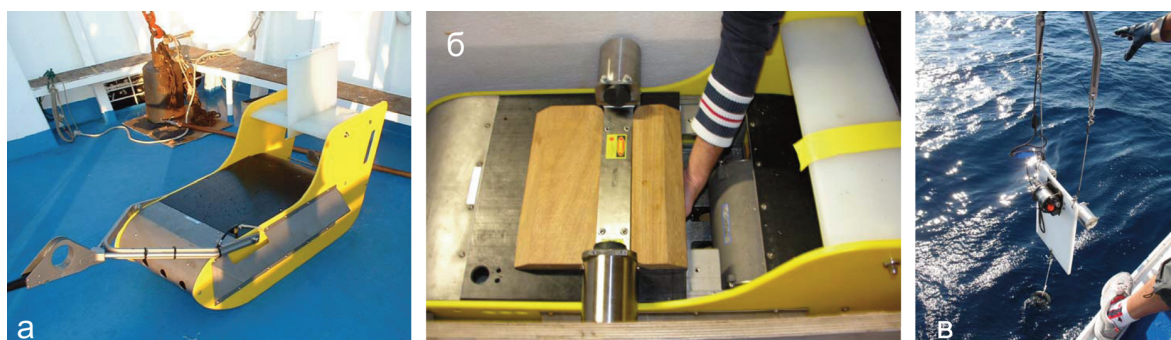
Рис. 5. Буксируемый носитель «NuShuttle»: а — общий вид, б — вариант с зондом ТРАП-7А, в — макет зонда ТРАП-8 вместе с STD-комплексом «miniPack» перед погружением на дрейфовой станции (28.07.2007)
