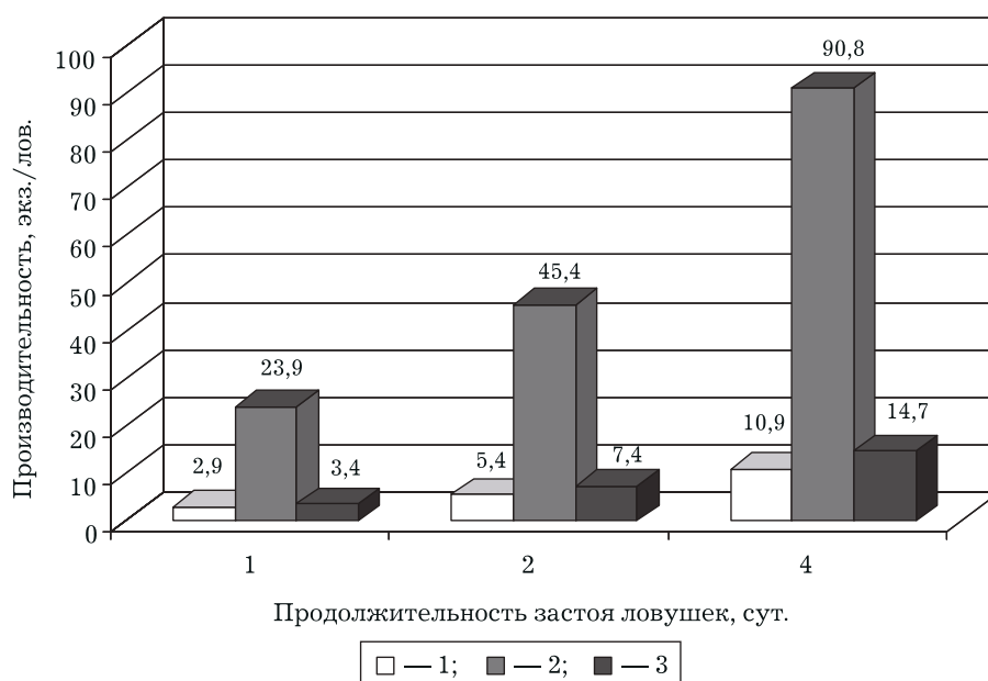
Рис. 4. Производительность крабовых ловушек различного типа в ноябре 2002 г.: 1 – ЭОЛ; 2 – АПЛ; 3 – НПЛ раскладного типа
