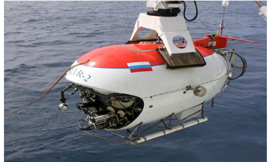
Глубоководный обитаемый аппарат «МИР» - до 6000 м
