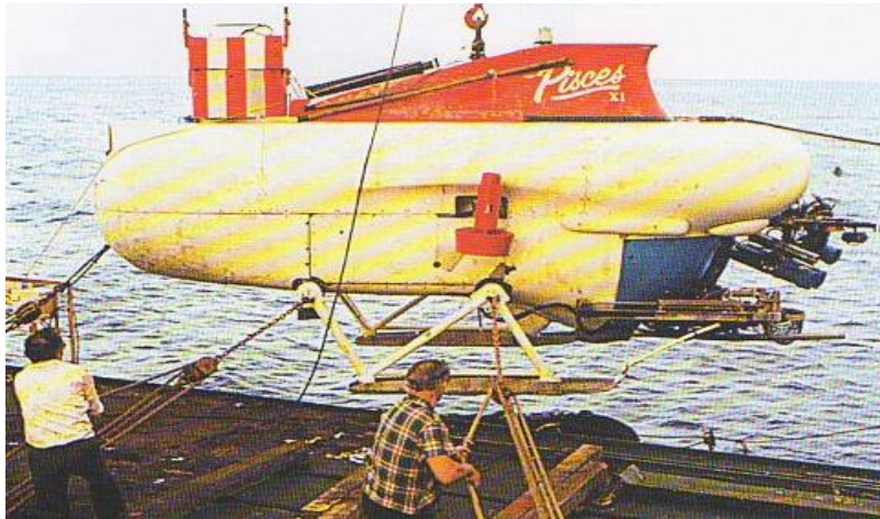
Глубоководный обитаемый аппарат «Пайсис» - до 2000 м
