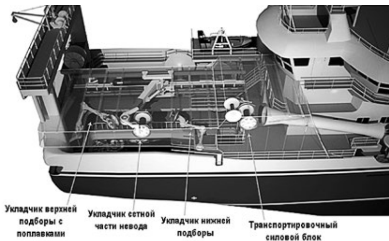
Рис. 103. Механизмы укладки невода
