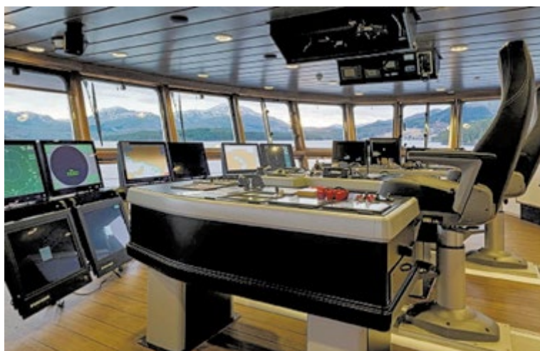
Рис. 109. Расположение в рулевой рубке аппаратуры управления судном, акустикой, приборами контроля хода трала, промысловым оборудованием
