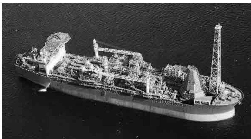
Рис. 1.14. Плавучая установка «Sea Rose» для добычи, хранения и отгрузки нефти способна принять из скважин до 140 тыс. т нефти
