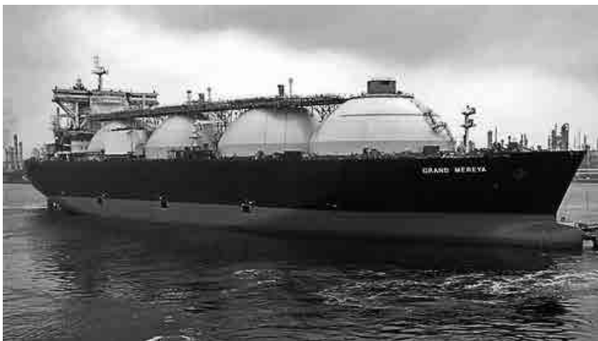
Рис. 2.30. Гигантский танкер-газовоз для перевозки сжиженного природного газа (вместимостью около 150 тыс. м 3 ) по проекту «Сахалин 2» ( www.sakhalin.info )
