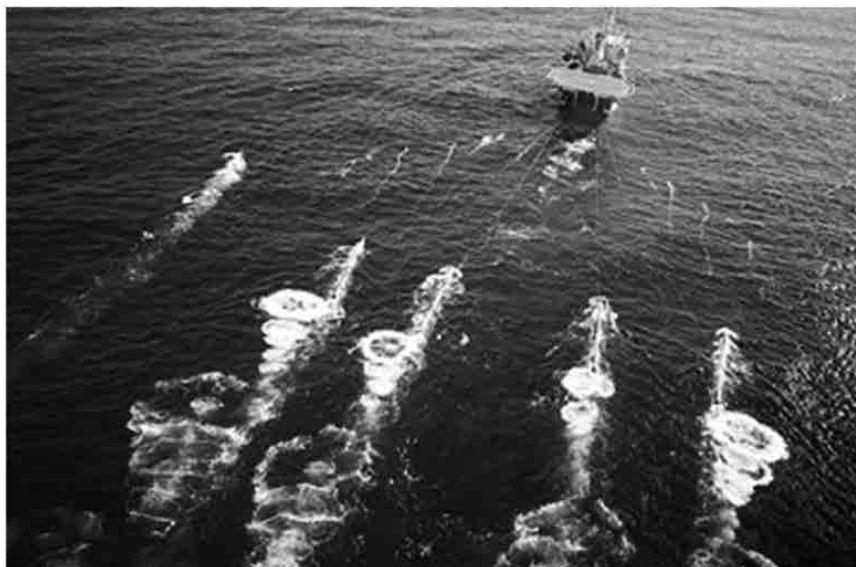
Рис. 2.7. Судно сейсморазведки в процессе съемки на морской акватории (www.planete-energies.com)
