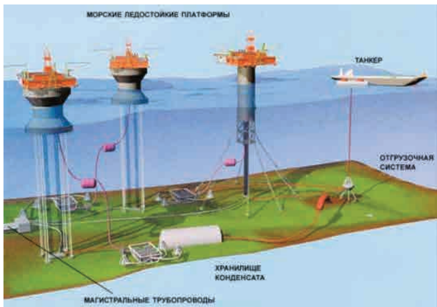
Рис. 2.4. Планируемые объекты обустройства Штокманского газоконденсатного месторождения в Баренцевом море [Осадчий, 2006]
