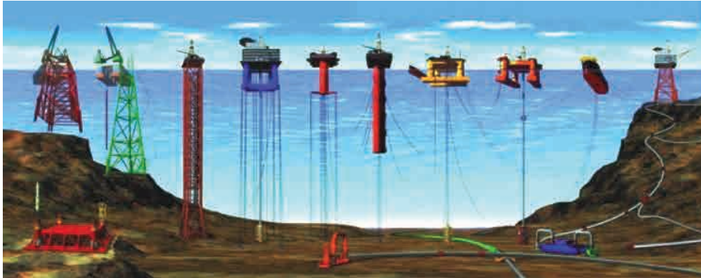
Рис. 1.8. Основные типы платформ для разведки и добычи углеводородов в Мировом океане ( www.oceanexplorer.noaa.gov )
