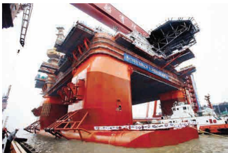
Рис. 1.16. Полупогружная буровая установка китайского производства, способная бурить скважины на глубинах воды до 10 тыс. м
