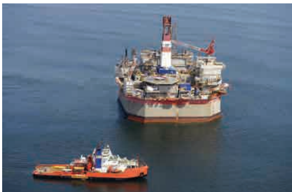
Рис. 2.8. Первая в России стационарная ледостойкая платформа «Моликпак», установленная в 1998 г. на шельфе Сахалина по проекту «Сахалин 2» ( www.sakhalienenergy.ru )
