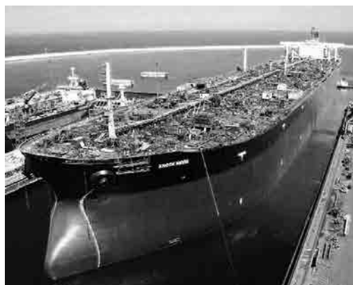
Рис. 1.20. Самый большой корабль на планете — супертанкер «Knock Nevis» (длина 460 м, дедвейт 565 тыс. т). В настоящее время используется как плавучее нефтехранилище
