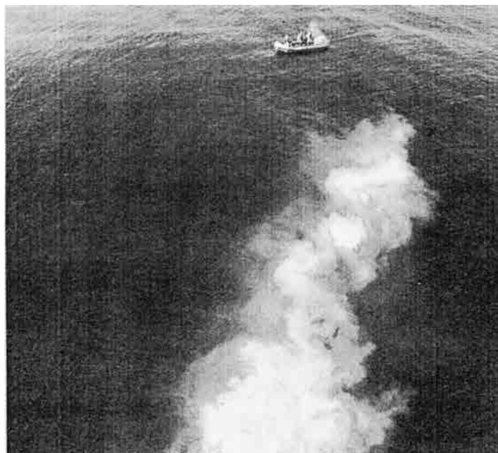
Рис. 2.16. Картина распространения в море твердой фазы после сброса бурового раствора при разведочном бурении
