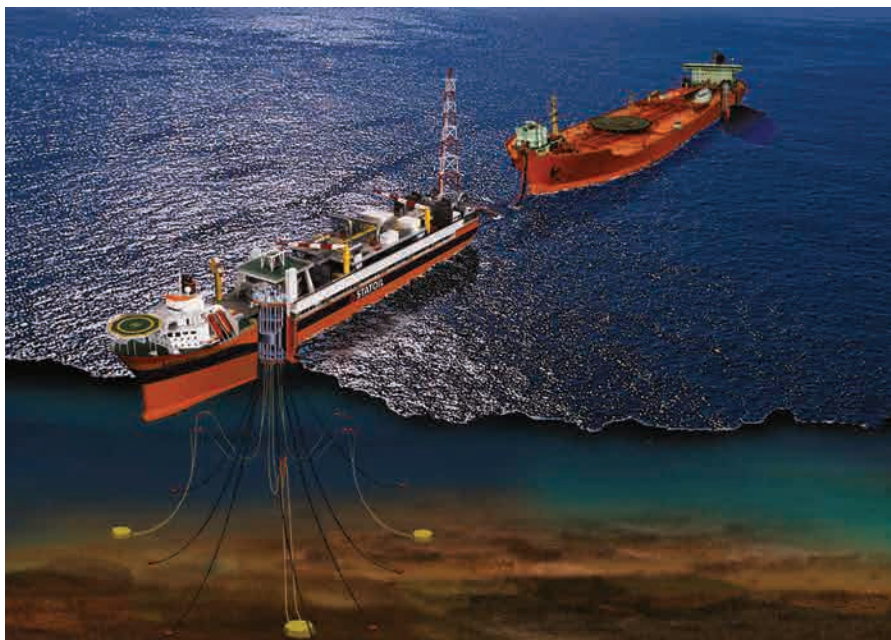
Морской нефтепромысел на основе плавучих установок FPSO для добычи, хранения и отгрузки нефти ( www.boemre.gov )
