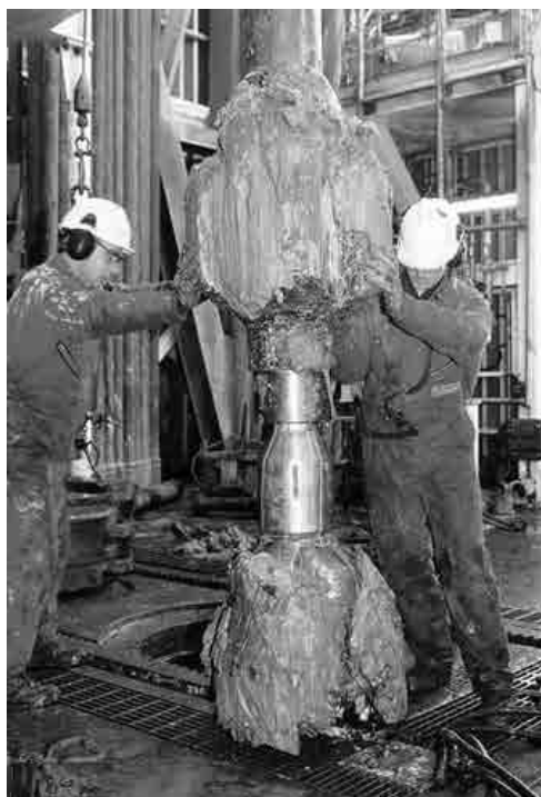
Рис. 3.1. Поднятый на поверхность скважины буровой инструмент [PIECSA, 2009]
