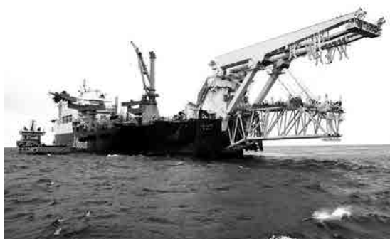
Рис. 2.11. Судно для укладки трубопроводов на морское дно (www.gazprom.ru)
