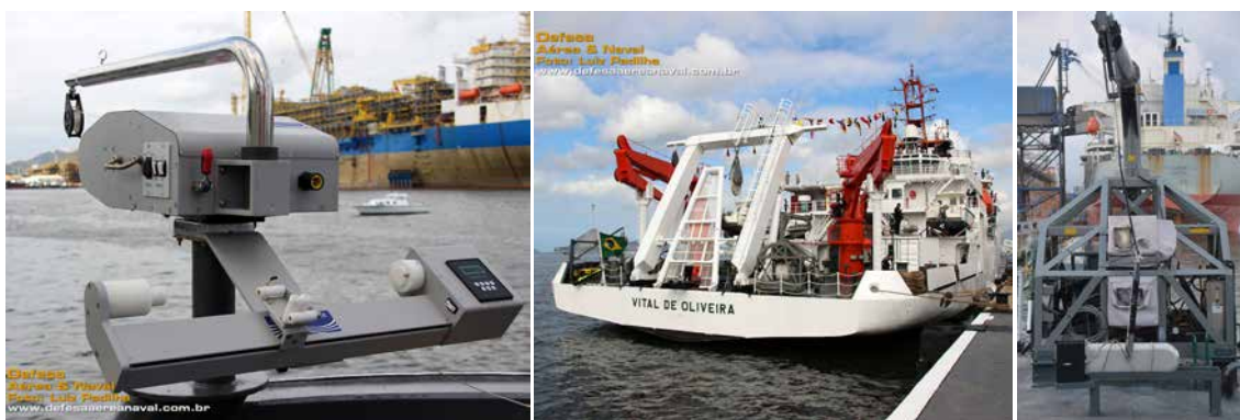
Рис. 2.62. Системы с возвращаемыми зондами типа U-CTD (слева) и типа MVP300 (справа), смонтированные в кормовой части НИС «Vital de Oliveira» (в центре)
