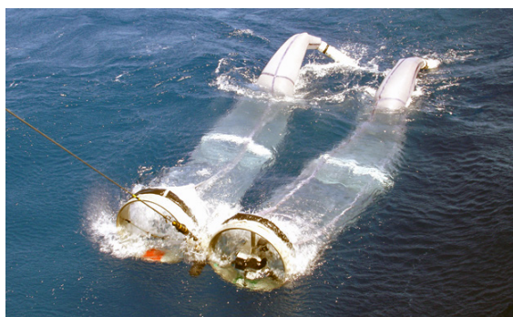
Планктономер LOPC, установленный во входном отверстии одной из сетей Бонго (слева) и смонтированный в верхней части ондулятора TRIAXUS (справа)
