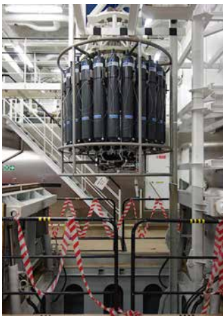
Рис. 3.6. Примеры использования мунпул для научной аппаратуры (слева) и воронкообразного направляющего раструба фирмы «Мустад» для постановки живяленного яруса под поверхность воды
