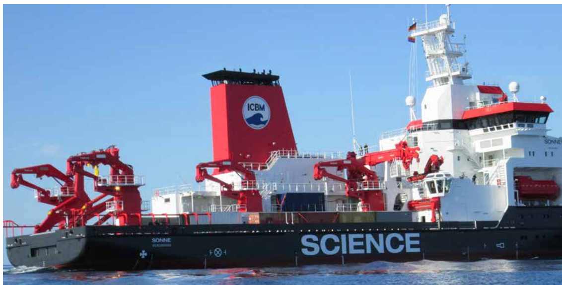
Рис. 2.47. Вид и расположение основных СПУ, установленных на кормовую часть и правом борту НИС «Sonne»
