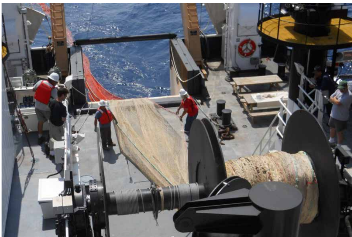
Рис. 3.1. Экипаж НИС «Bell M. Shimada» (США) выбирает пелагический трал на кабельно-сетные барабаны
