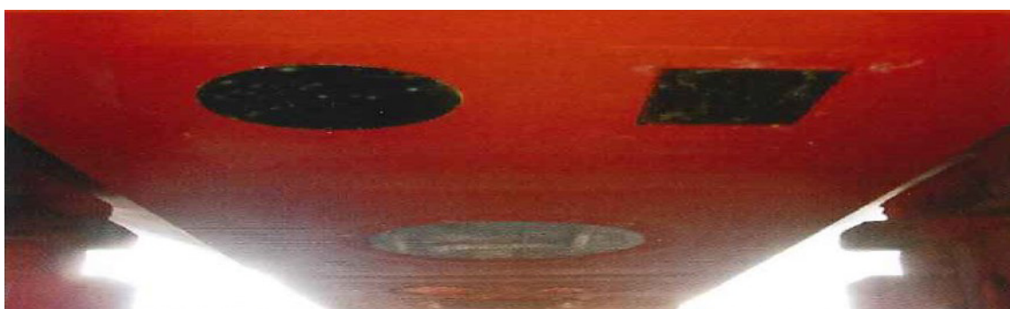
Рис. 1.43. Антенны гидроакустической аппаратуры, смонтированные на днище судна
