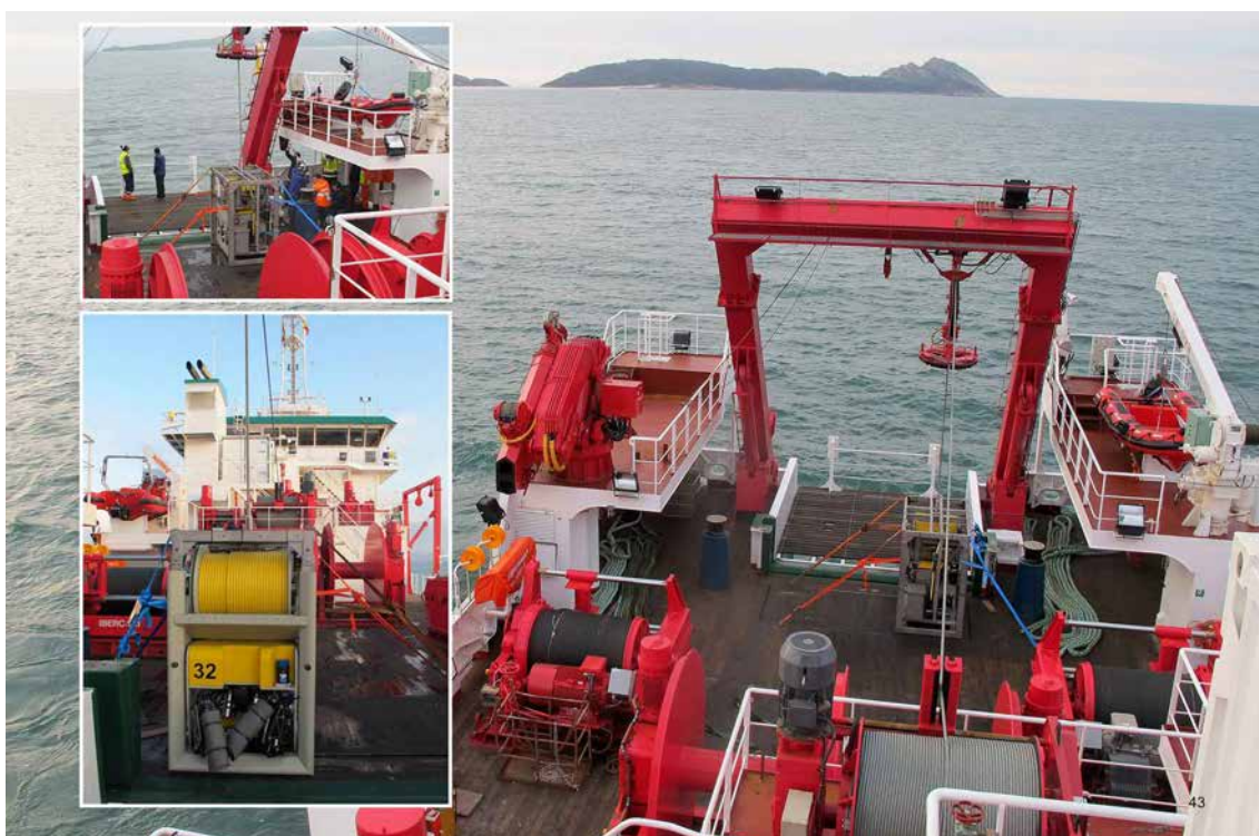
Рис. 1.18. Вид лебедок и спуско-подъемных устройств, расположенных на кормовой палубе НИС «BIPO INAPESCA». Во вставленных кадрах запечатлены моменты работы с ROV Super Mohawk II
