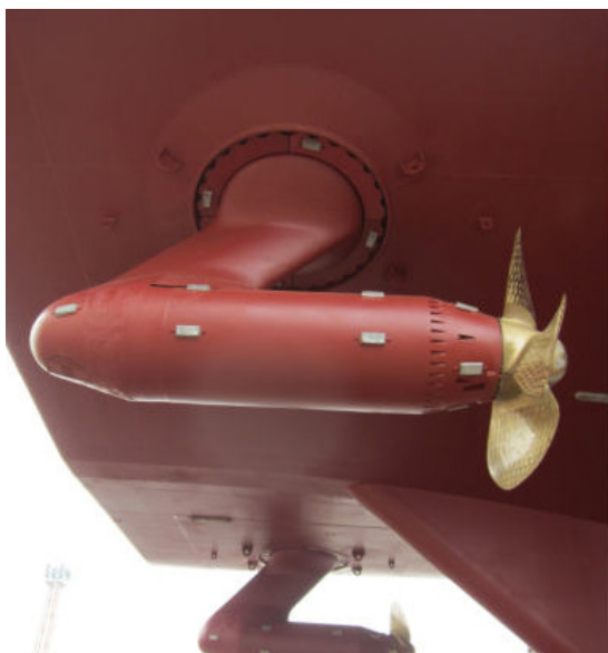
ВРК типа АВВ Аzipod C0980, установленные на НИС «Ке Хуе», и схематический вид их внутреннего устройства в разрезе
