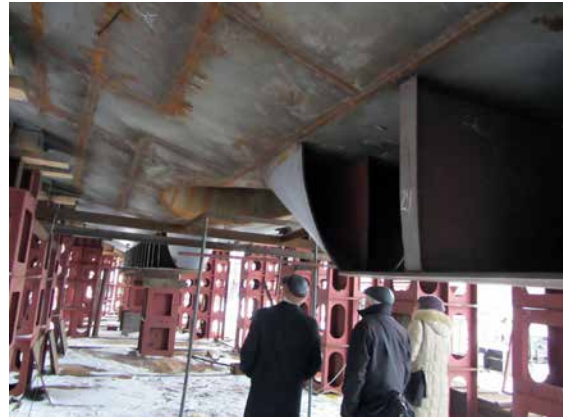
Рис. 3.5. Вид устройства конструкции мунпул в днище нового сейнер-траулера в процессе строительства судна
