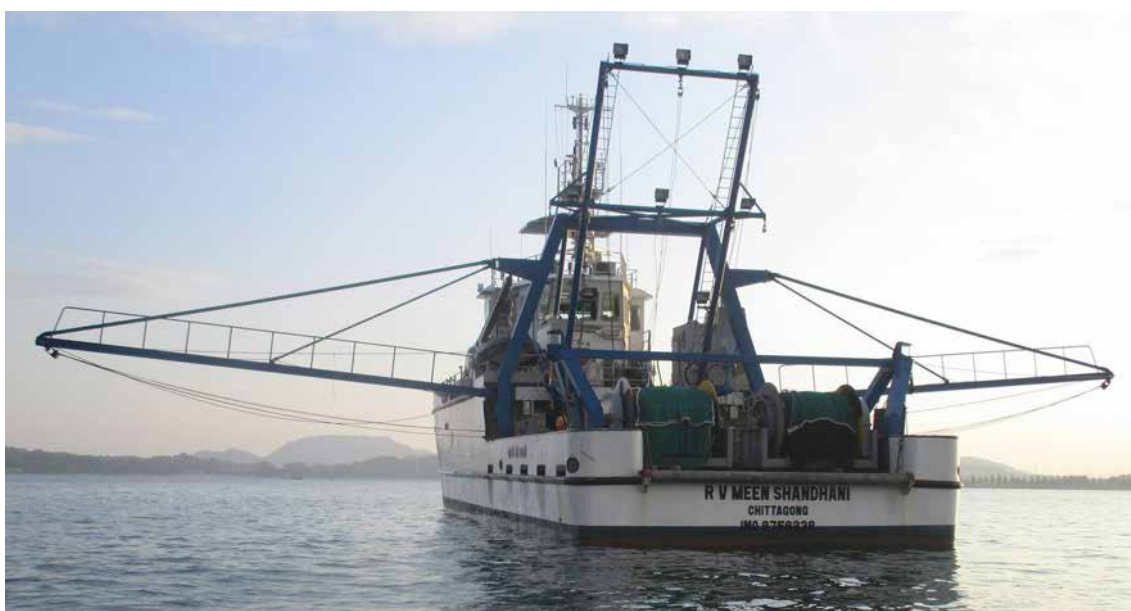
Рис. 1.51. Вид на корму НИС «Meen Shandhani» с развернутым набором промыслового вооружения
