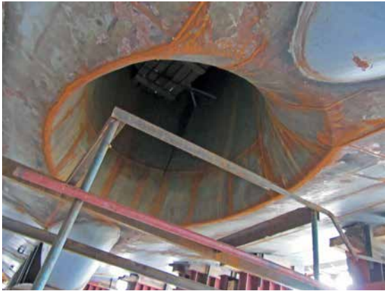
Рис. 3.5. Вид устройства конструкции мунпул в днище нового сейнер-траулера в процессе строительства судна
