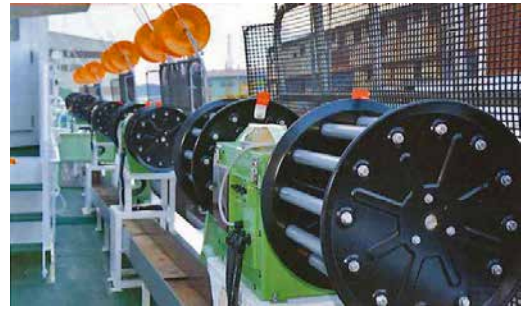
Рис. 3.4. Джиггерные машинки и люстры освещения (в состоянии «по-походному») на НИС «Kaiun Maru»
