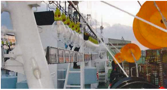
Рис. 3.4. Джиггерные машинки и люстры освещения (в состоянии «по-походному») на НИС «Kaiun Maru»
