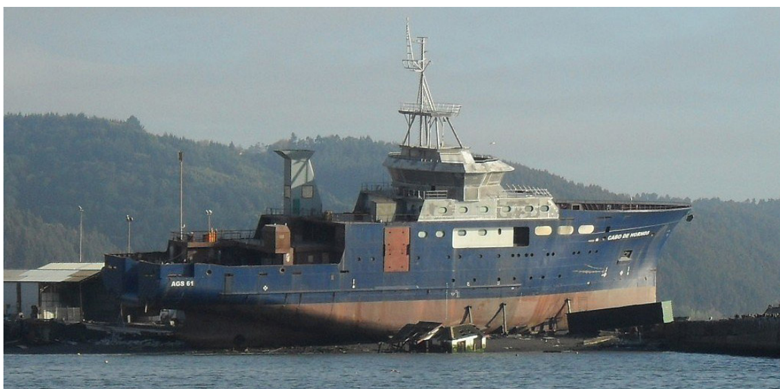
Рис. 1.14. Вид НИС через некоторое время после цунами с временными креплениями
