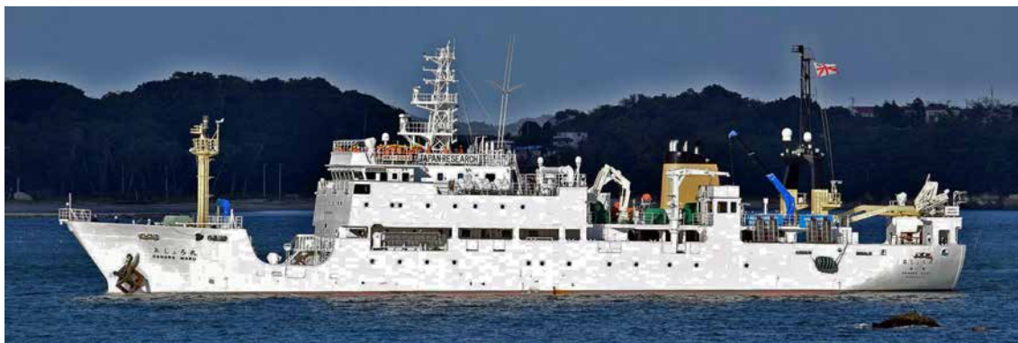
Вид НИУС «Oshoro Maru» по левому борту, где в кормовой части располагаются траловые рыболовные устройства и джиггерные машины для ловли кальмара (вдоль борта), а оборудование для постановки и выборки дрейфтерных сетей и устройства для ярусного лова находятся в носовой части рабочей палубы
