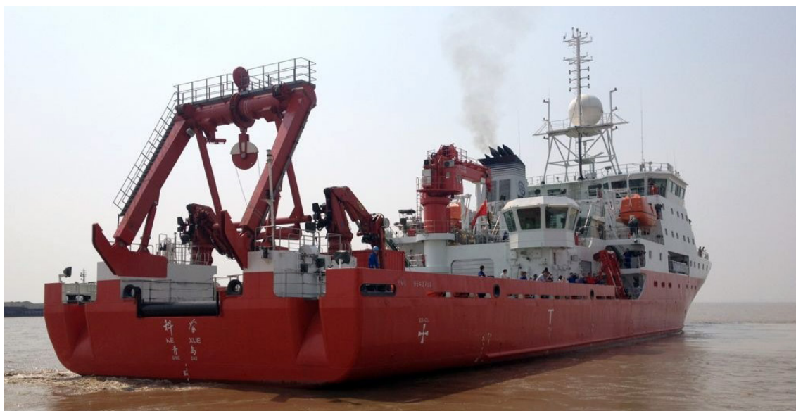
Рис. 2.35. Вид и расположение основных СПУ, установленных на кормовую часть и правом борту НИС «Ке Хуе»
