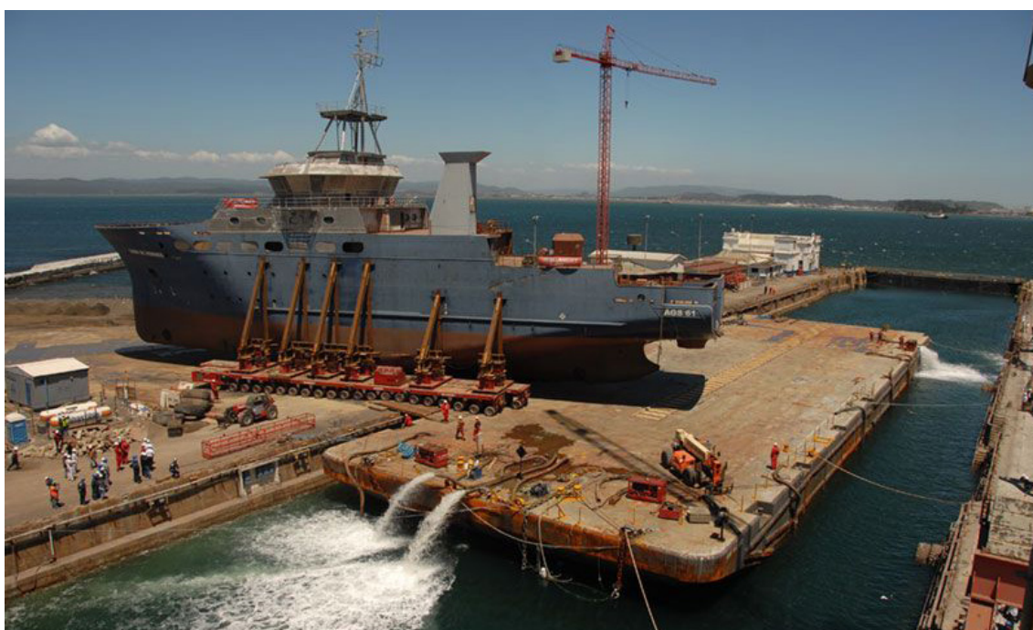
Рис. 1.15. Момент передвижки НИС «Cabo de Hornos» на спецбаржу
