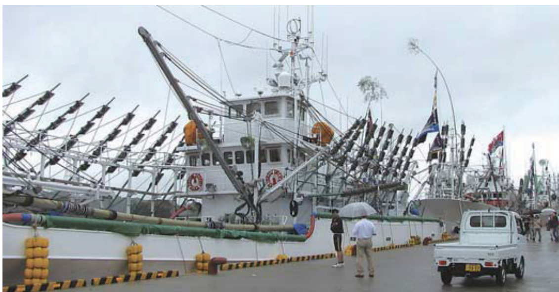
Рис. 1.30. НИС «Chiba Maru» с развернутыми светильниками по левому борту
