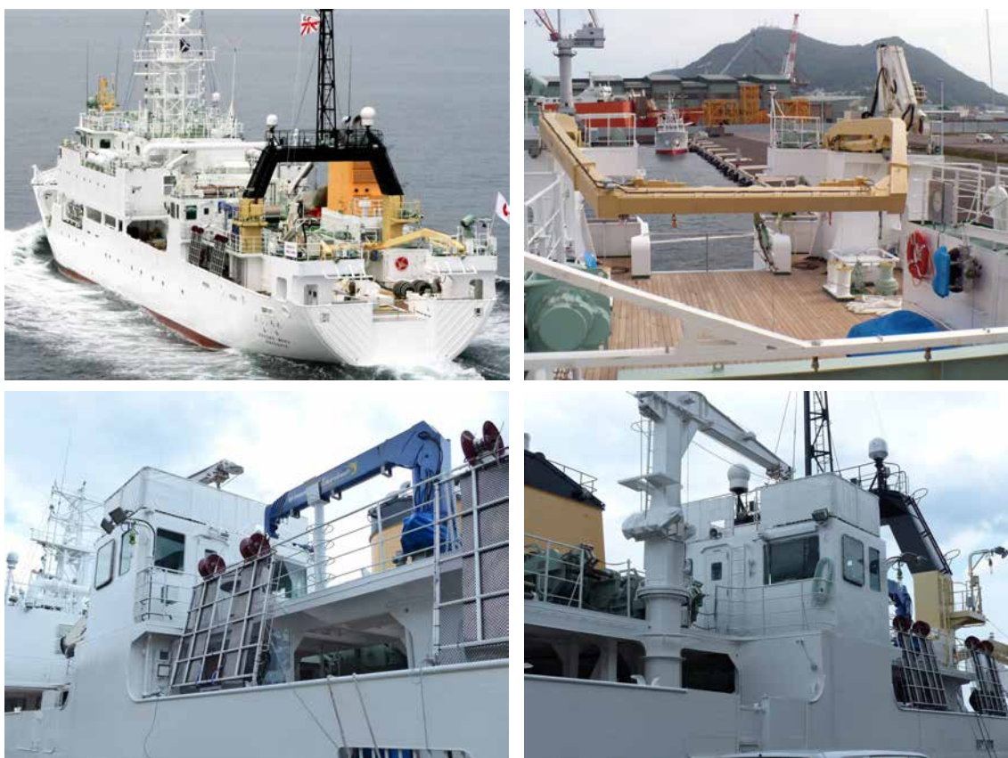
Рис. 2.22. Отдельные элементы конструкции и устройства НИУС «Oshoro Maru»: сверху – кормовая палуба, вид с моря и с надстройки; внизу – вид на кабину управления палубными спуско-подъёмными устройствами и прилегающее пространство, слева от кабины – площадка для забортных работ с зондами, справа видны джиггерные машинки и стрела лебедочной системы работы на ходу судна MVP
