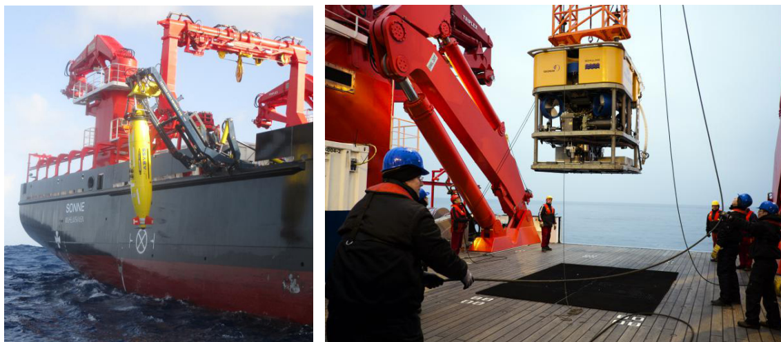
Спуско-подъемные операции с AUV(слева) и ROV (справа) на борту ЭС «Sonne»
