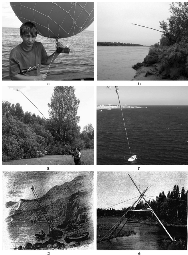
Рис. 3.1. Приёмы фотографирования и наблюдения рыб через вповерхность воды: а – воздушный шар с кассетой для фотоаппарата; б – фотоаппарат над «тропой» горбуши; в – фотокамера на песте; г – фото с буксируемого парашюта; д – вышка для слежения за подходом тунцов (Кале, 1926); е – вышка Э.Л. Бакштанского над лососевой речкой на Кольском полуострове
