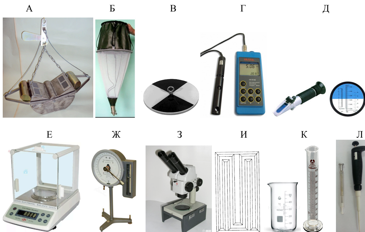
Рис. 6. Оборудование, необходимое для исследования запасов цист артемии: А – дночерпатель; Б – планктонная сетка; В – диск Секки; Г – термооксиметр; Д – рефрактометр; Е – весы (точность порядка \pm 0,1 мг); Ж – торсионные весы; З – бинокулярный микроскоп; И – камера Богорова; К – мерный стакан и цилиндр; Л – штемпель-пипетки
