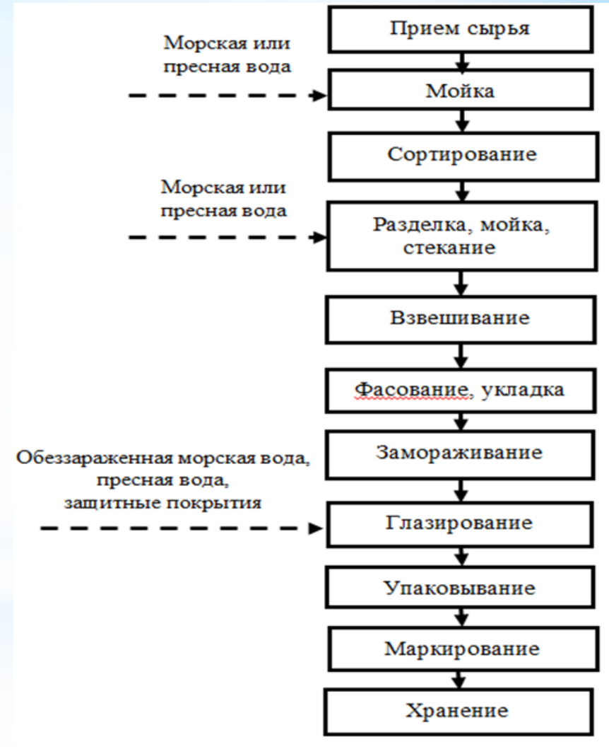
Технологическая схема производства мороженой рыбной продукции
