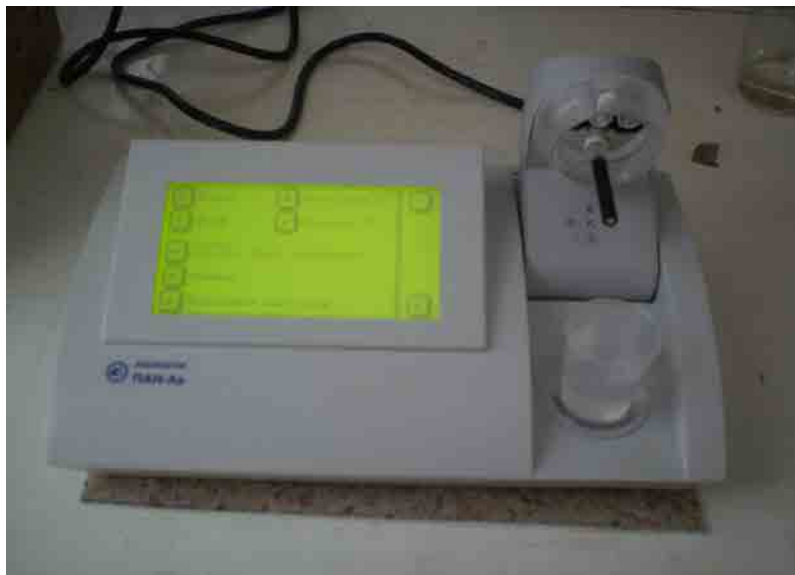
Рис. 2. Анализатор для определения мышьяка ПАН-As
