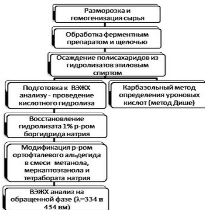
Рис. 1. Схема получения гиалуроновой кислоты
