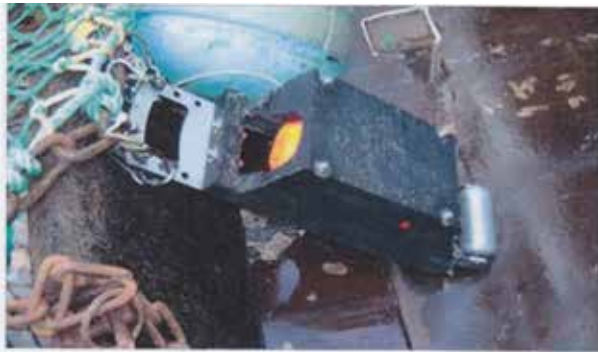
Рис. 10.54. Датчик контакта нижней подборы трала или грунтотропа с грунтом и его установка на трале
