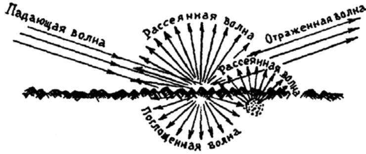
Рис. 7.4. Отражение, рассеяние и поглощение акустических колебаний морским дном
