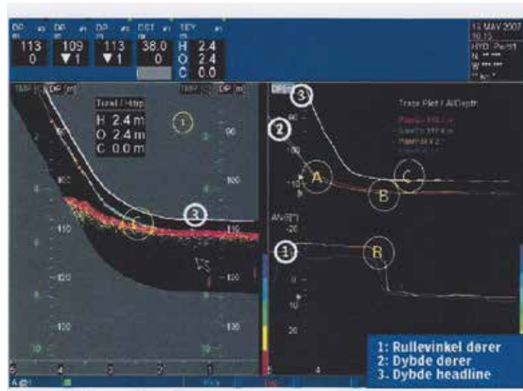
Рис. 10.56. Пример отображения результатов измерений и контроля характеристик и параметров траловой системы на экране бортового монитора системы Сканмар, в т. ч. показана посадка донного трала на дно: сначала траловая лебедка тормозится, когда доски находятся примерно в 10 м над грунтом (А). Погружение досок замедляется, а трал продолжает опускаться с прежней скоростью, когда доски коснутся грунта (В) скорость судна несколько увеличится, доски становятся вертикально, распор увеличивается. Через короткое время трал садится на грунт (С).
